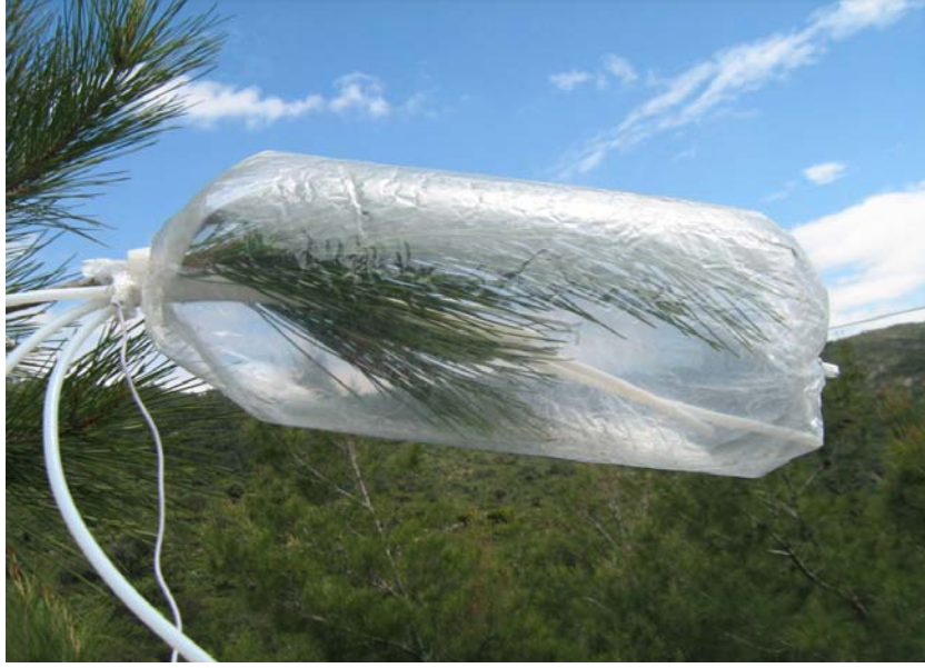
Şekil 1. Çalışma kapsamında örneklenen çam ağaçları üzerine yerleştirilen dinamik test odası.
