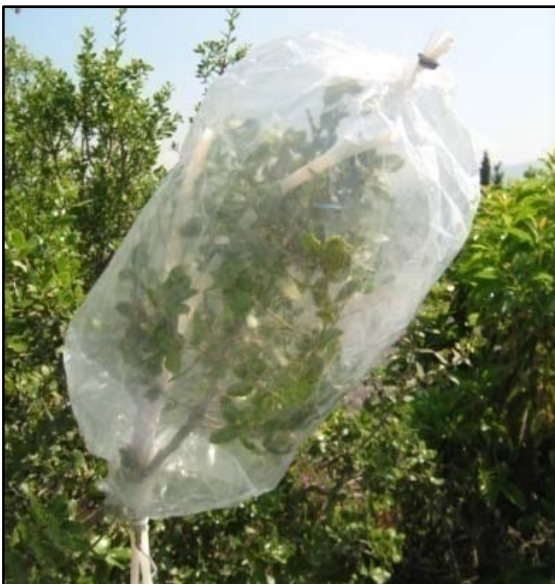
Şekil 2. Çalışma kapsamında örneklenen makiler üzerine yerleştirilen dinamik test odası.
