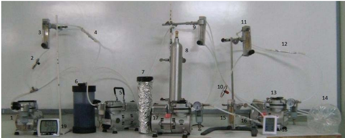
Şekil 4. Çalışmada kullanılan örnekleme düzeneği. (1,5,13,17 pompa, 2,10 vana, 3,9,11,15 rotametre, 4,12,16 tenax tüp, 6 silika jel kolonu, 7 potasyum iyodür kolonu, 8 aktif karbon kolonu, 14 dinamik test odası, 18 test odası sıcaklığı ölçer, 19 dış hava sıcaklık ve nem ölçer).
