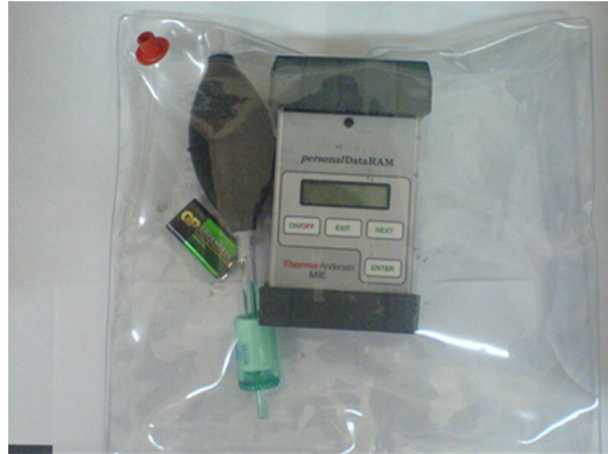
Şekil 2. Thermo Scientific Personal DataRAM pDR-1000AN Monitör marka-model, pasif, gerçek zamanlı kişisel aerosol monitör/veri kayıt cihazı
