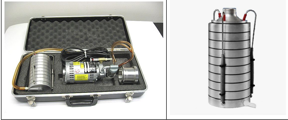
Şekil 2.1. Çalışmada kullanılan basamaklı ayırıştırıcı sistemi genel görünüşü
