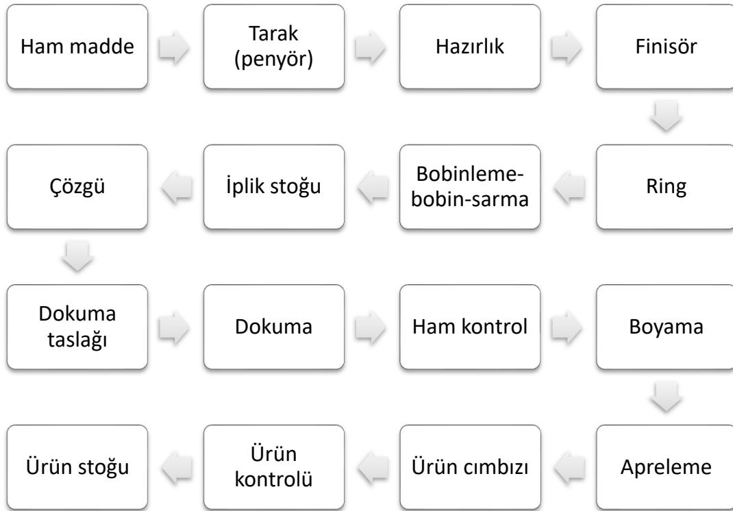
Şekil 1. Seçilen tesis için kumaş üretimi akış şeması
