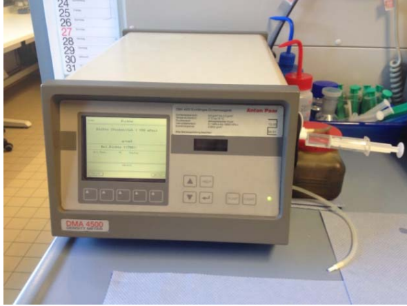
Anton Paar DMA 4500 Salınlı U Tüp Yoğunluk Ölçer
