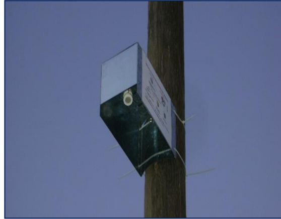
Şekil 2. Çalışmada kullanılan pasif örnekleyiciler ve örnekleme esnasındaki konumları
