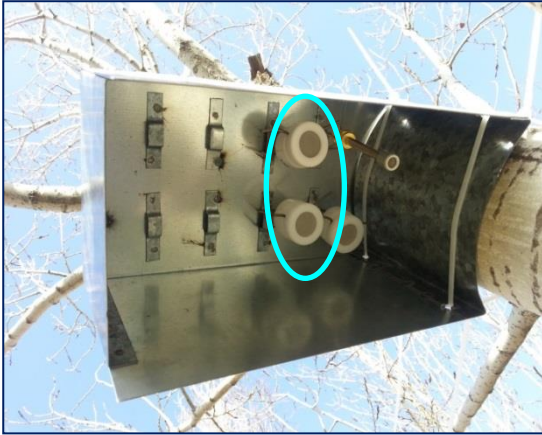
Şekil 2. Çalışmada kullanılan pasif örnekleyiciler ve örnekleme esnasındaki konumları
