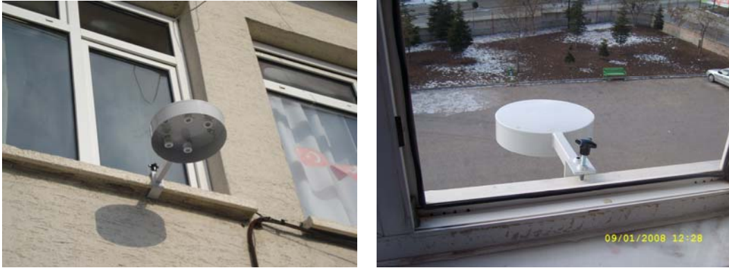
Şekil 4. Pasif örnekleme cihazlarının örnekleme esnasındaki konumları
