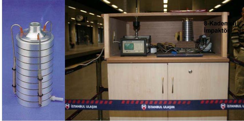
Şekil 2. 8 kademeli impaktör cihazının genel görünüşü ve yerleştirildiği platform
