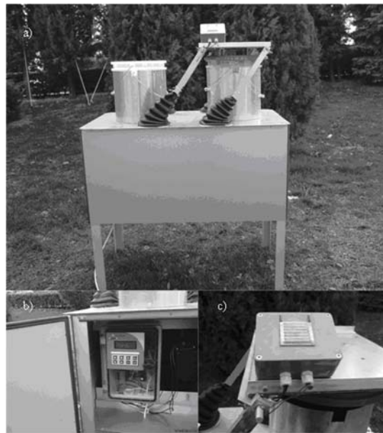
Şekil 2. Bu çalışma için üretilmiş olan yağ/kuru örneklemesi sistemi a) örnekleyicinin arazideki görünüşü b) PLC ünitesi c) yağış sensörü.
