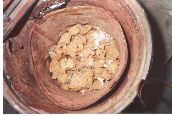
Fotoğraf 8. Biriketlerin yakılması sonucu oluşan yanma kamarası
